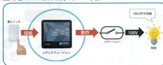
【図8】 スマートフォンアプリで操作したときのリレーの挙動
