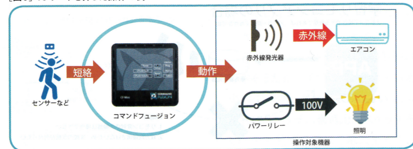
【図6】 IOポートを介した操作の例
