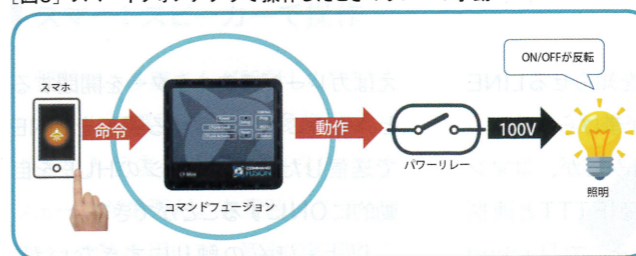
【図8】 スマートフォンアプリで操作したときのリレーの挙動
