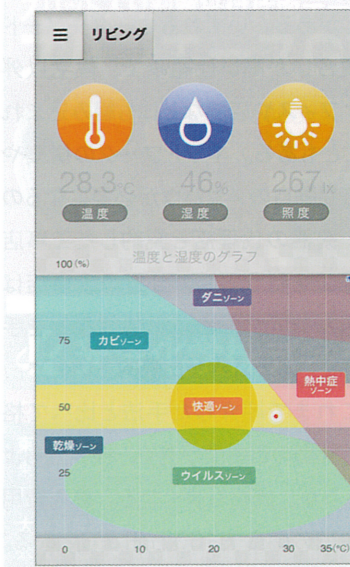
iRemoconのアプリの画面。照度センサーの機能があり、その数値を見ることである程度照明のON/OFFを判断できる
